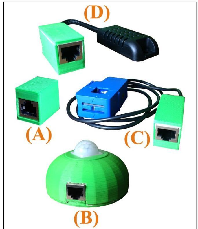
Fig. 2. Caja de sensores impreso en 3D, (A) Temperatura, (B) Detección de Movimiento, (C) Sensor de corriente alterna, (D) Humedad Relativa.
